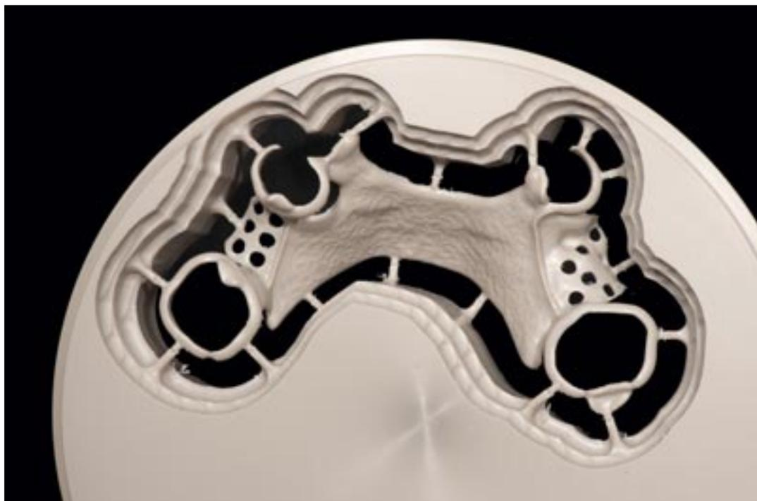
Fig. 28. Estructura fresada de PEEK sin rellenar, aún en blanco. El maxilar fue escaneado con un escáner oral.
